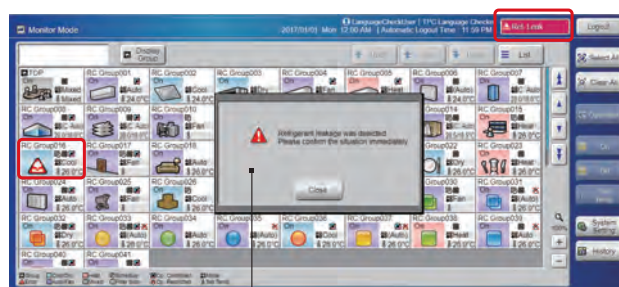
Wyskakujące okienko z informacją o wycieku
